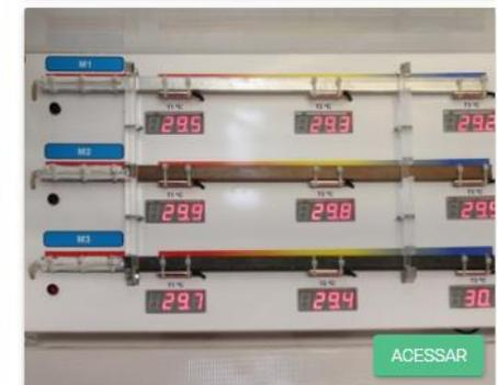
● **Condução de calor em barras metálicas**
